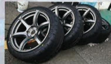
比較用のSタイヤはいつものアタック時と環境を揃えるためにタイヤウォーマーで余熱してのアタック。逆にヴァリノを使うのであるうモデルクラスのユーザーでタイヤウォーマーを使う人はいないだろうという想定で、テストタイヤ(ヴァリノ)は余熱なし。スタート時(冷間)の空気圧は1.7kg/cmにセッティングして車両に組み込まれる。メーカー側の指定は温度2~2.1kg/cm程度だという。
