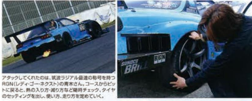
アタックしてくれたのは、筑波ラジアル最速の称号を持つRGN(レディ・ゴー・ネクスト)の青木さん。コースからピットに戻ると、熱の入り方・減り方など随時チェック、タイヤのセッティングを出し、使い方、走り方を定めていく。
