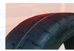
扱いやすさの秘密はラウンドしたトレッドの形状にもある。滑り出しもグリップの回復も穏やかで、コントロールしやすいのが特徴
